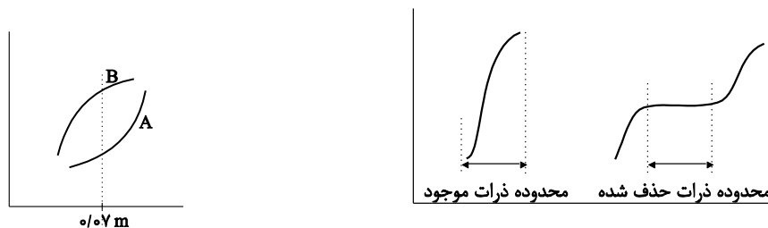
شکل ۶: منحنی A خاک یکنواخت با درشت‌دانه بیشتر و خاک B دانه‌بندی یکنواخت با ریزدانه بیشتر
